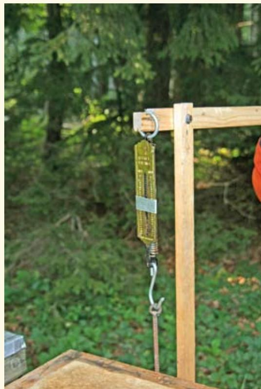
Eine einfache Hebelkonstruktion aus Holzleisten mit einer Federzugwaage ermöglicht das Wiegen mit geringem Kraftaufwand und ein Ablesen in Augenhöhe.
