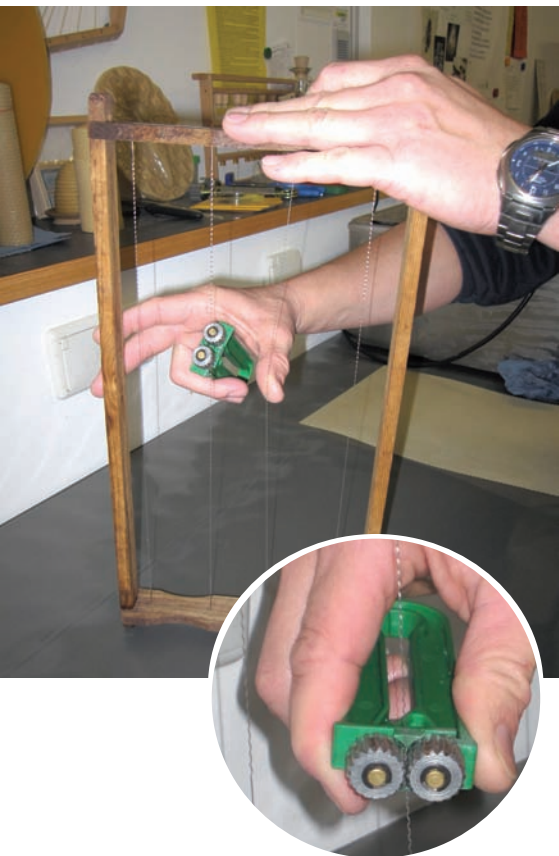
Der Rähmchenspanner spart das Lösen des Drahtes und sorgt für eine stramme Drahtung. Die „Klangprobe“ zeigt, wie gut das Rähmchen gespannt wurde.
